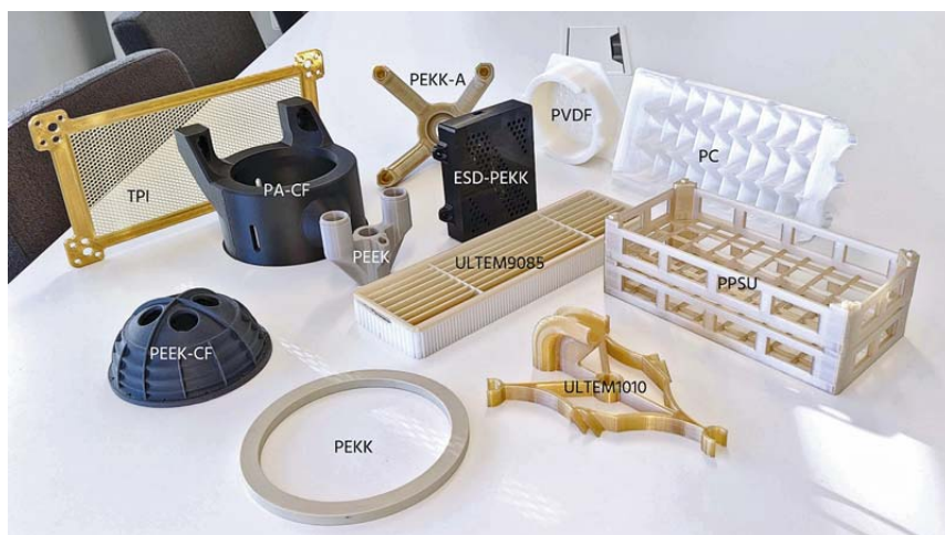
Obr. 3: Pokročilé 3D tiskárny dnes umožňují velmi efektivně a bez zbytečného odpadu vyrábět i díly z nejdolnějších termoplastů, jako jsou ULTEM, PEEK, PEKK apod. Ty na obrázku, připravené s finskou technologií MiniFactory, se uplatňují nejen ve strojírenství, ale také v dopravních prostředcích, leteckém a kosmickém průmyslu, potravinářství, energetice a dalších odvětvích (foto: MiniFactory).
