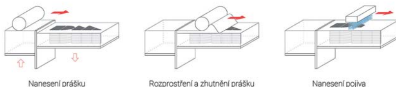
Obr. 2: Proces tisku jedné tiskové vrstvy technologií Binder Jetting
