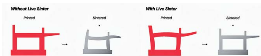
Obr. 4: Srovnání výroby kovového dílu technologií Binder Jetting bez použití a s použitím softwaru Live Sinter
