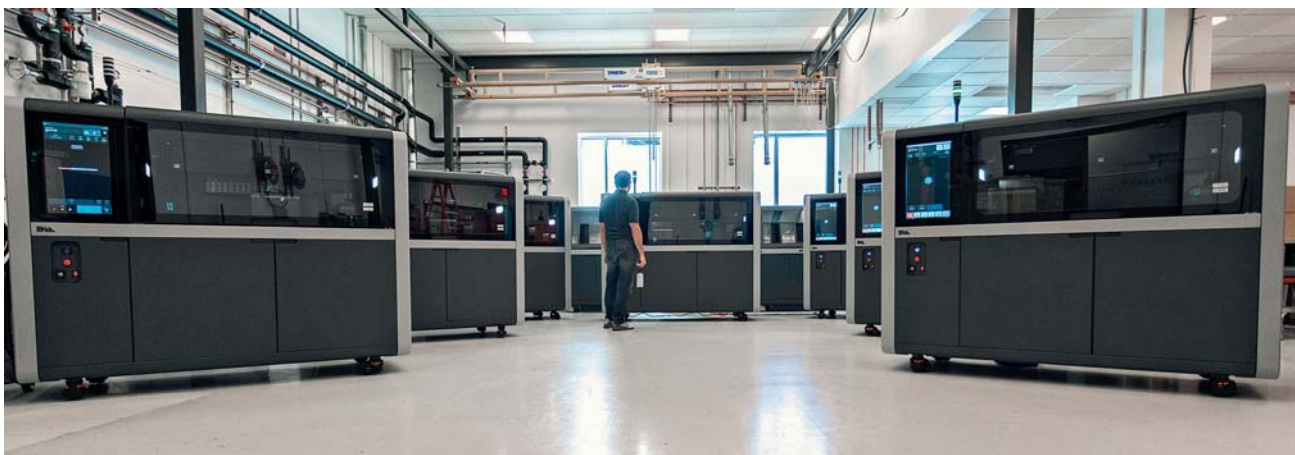
Obr. 1: Průmyslová aditivní výroba technologií Binder Jetting (zařízení Desktop Metal Shop System)
