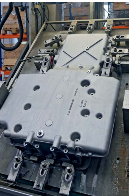
Obr. 2: Dílec na lodní motor pro zákazníka Volvo – obrábění a příprava podkladů pro kalkulace v EDGECAMu
