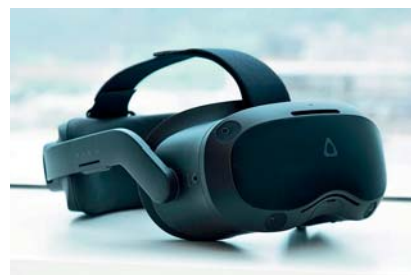
Obr. 4: S nezávislými headsety, jako je HTC VIVE Focus 3, odpadají problémy s převozem PC a dalších komponent systému. Vše je komfortní a bez kompromisů v rozlišení či zorném poli.
